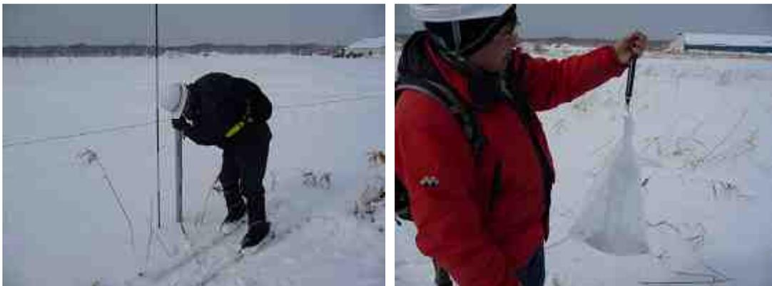
図 2-5-4 神室式スノーサンプラーによる積雪サンプルの採取と積雪水量の
