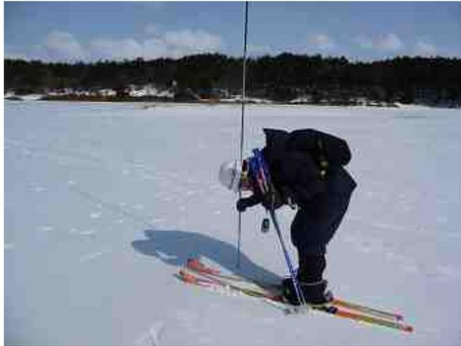
図 2-5-2 測深棒による積雪深測定
