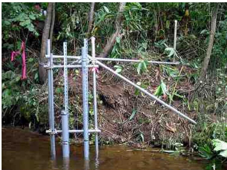
図-7 水位濁度計設置状況
