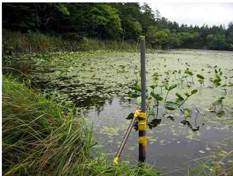
図-3 水位計の設置状況（#60）
