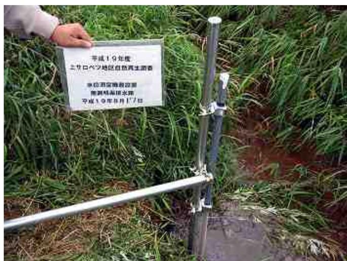
図-4 明渠における水位計設置状況（「明渠調査地点・南」の例）
