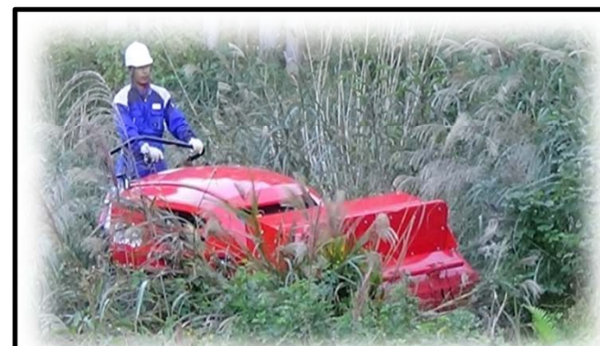
ブラッシュカッターによる大型機械 地拵 下刈への活用の可能性
