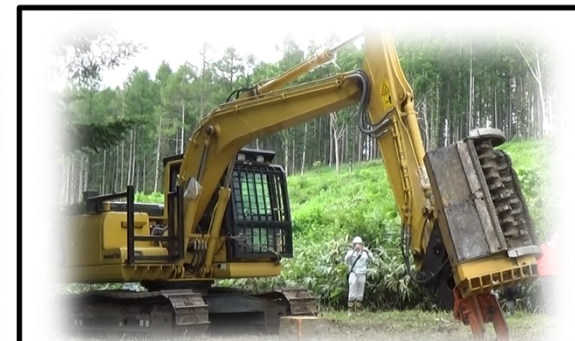
ブラッシュカッターによる大型機械 地拵 下刈への活用の可能性
