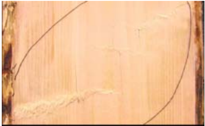
写真4 「もめ」の拡大図(トドマツ)
