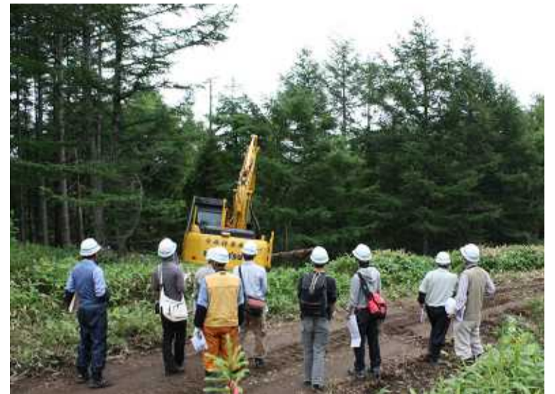
ハーベスタによる伐倒作業
