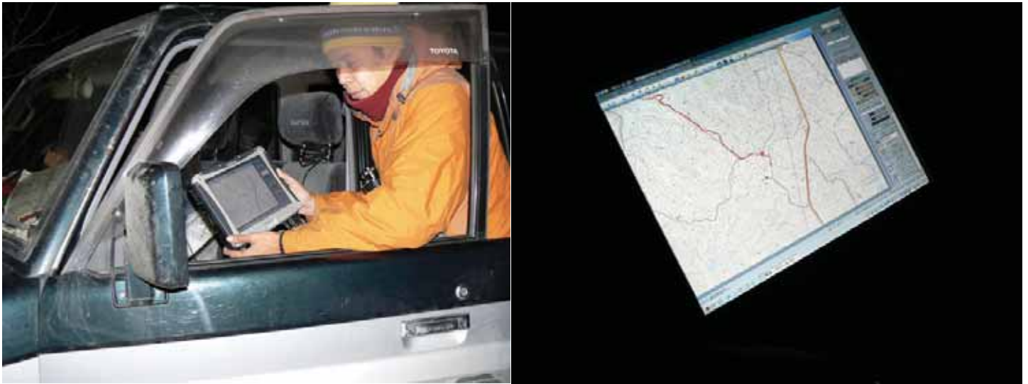
図-7 PC と GPS を用いたナビゲーションシステム 左：ToughBookPC 右：車内での現在地の表示の様子
