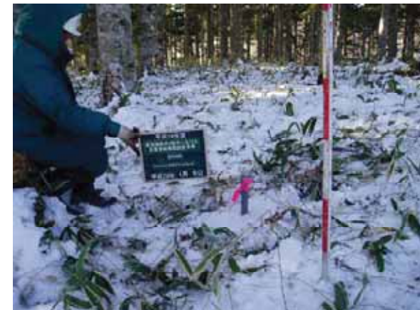
凍結深計設置 No.4
