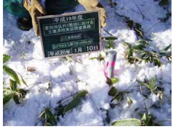
凍結深計設置 No.10
