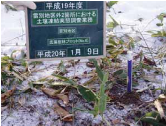
凍結深計設置 No.6
