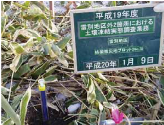
凍結深計設置 No.3
