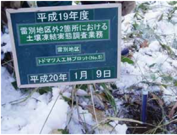
凍結深計設置 No.5
