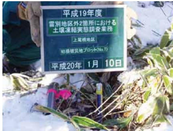
凍結深計設置 No.7
