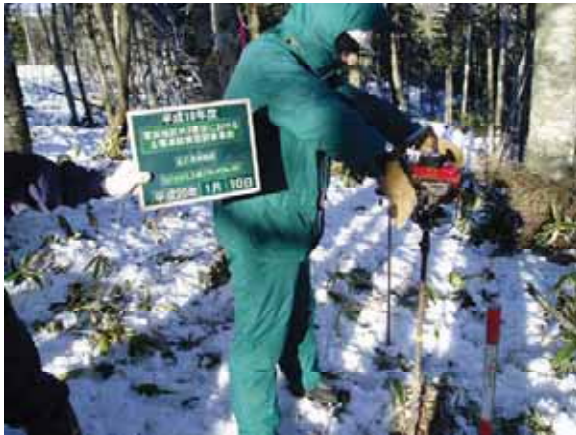
凍結深計設置 No.10
