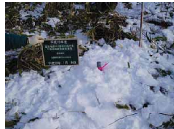
凍結深計設置 No.3
