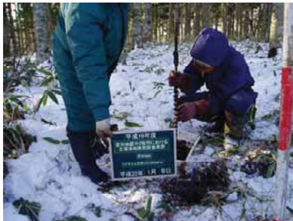
凍結深計設置 No.4
