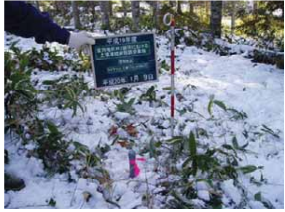
凍結深計設置 No.5
