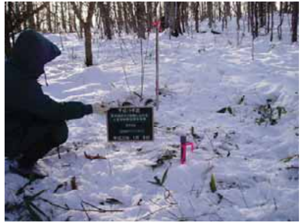
凍結深計設置 No.6
