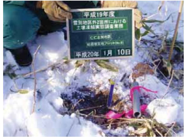
凍結深計設置 No.9
