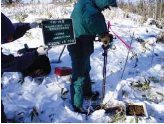
凍結深計設置 No.9
