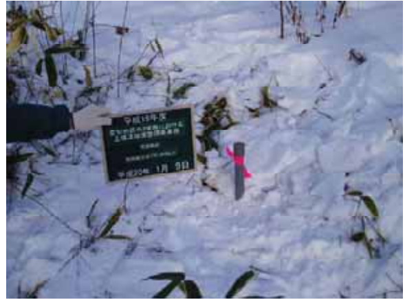
凍結深計設置 No.1
