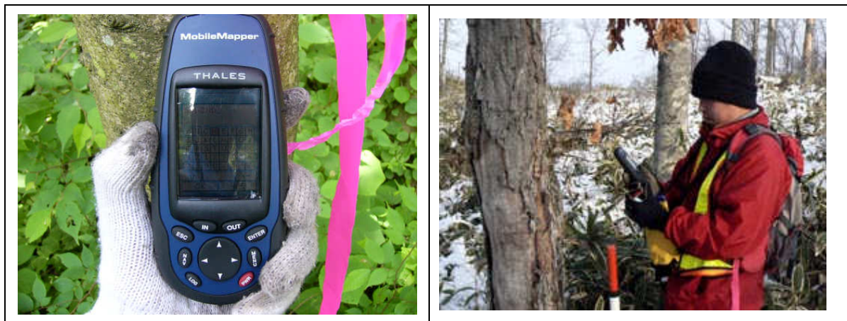
図 2-3 左 : MobileMapper (Thales Navigation 社)、右 : 立木位置の測位風景
