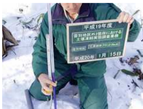
写真-2 メチレンブルー水溶液凍結の様子
