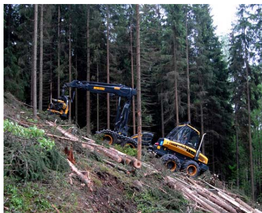
写真－3 ハーベスタの傾斜地作業 (フィンランド) 写真 Ponsse 社
