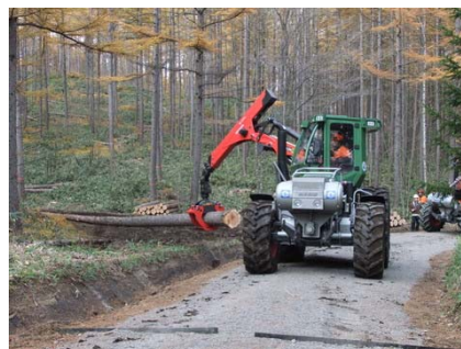
写真－4 トラクタによる木寄せ作業 (鶴居村にて)
