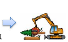
プロセッサ(枝を切る、長さを揃える)
