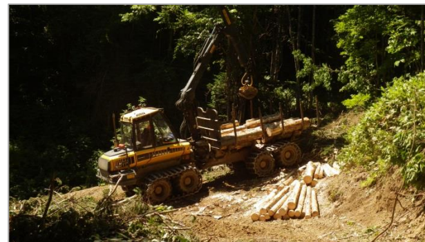
フォワーダによる集材作業 (西紋別支署)
