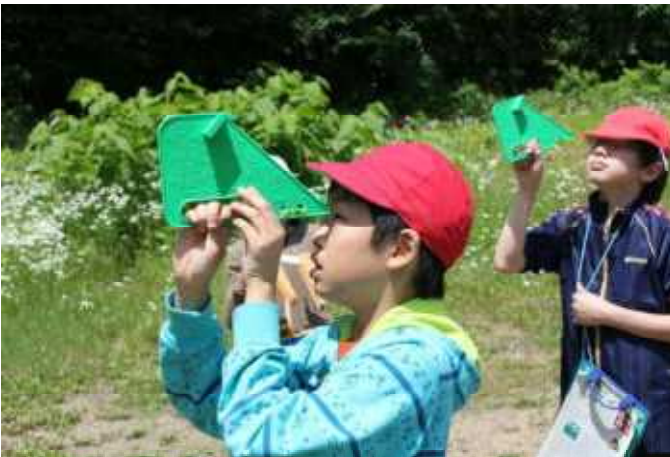
タンジェントハイトゲージで樹木の高さを測定中
