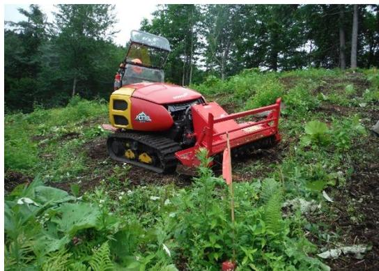
乗車型多目的造林機械による下刈作業
