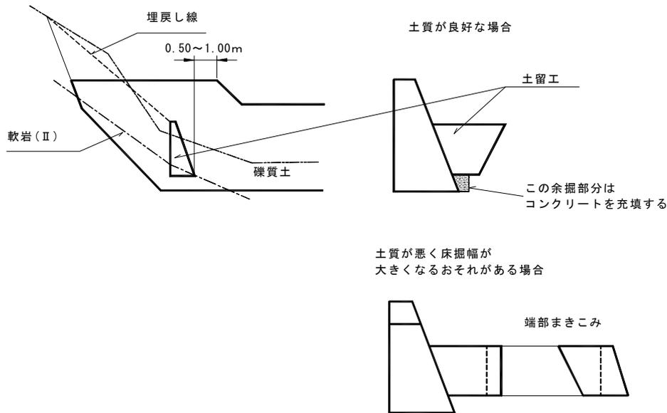
土留工の延長は、原則として堤体の床掘が影響する範囲とする。
