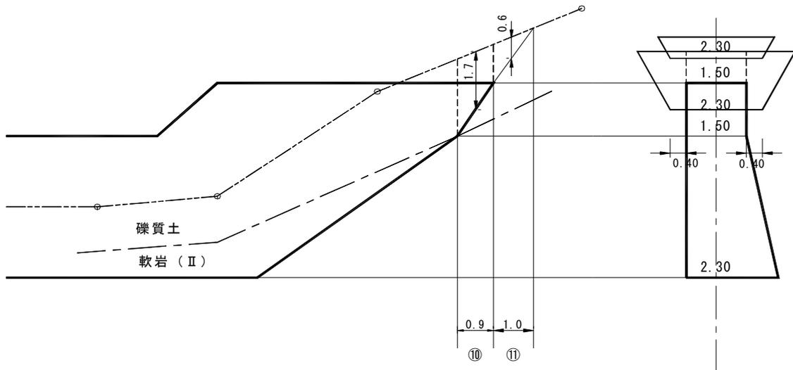
⑪の部分の床掘の下幅は、放水路天端厚に余掘を加えた幅とする。
