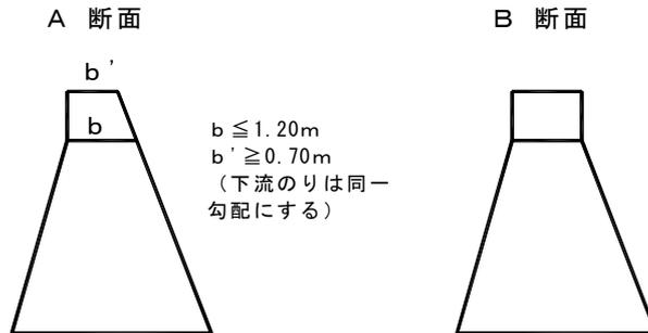
ア Aの断面は、放水路天端厚1.20m以下のもので袖天端厚が0.70m未満にならない場合に採用する。
