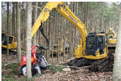
高性能林業機械による 列状間伐
