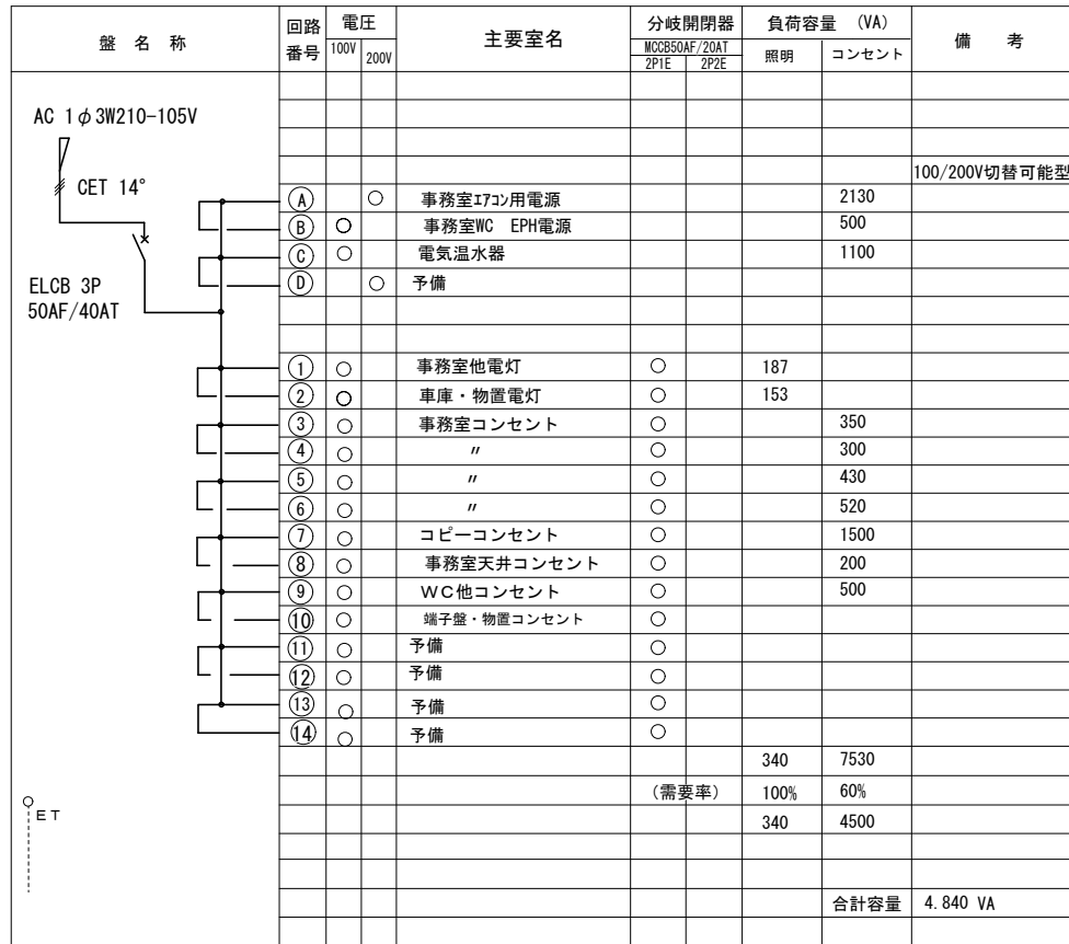
事務所電灯分電盤 結線図
