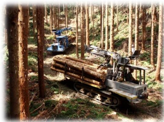
(森林作業道でのフォワーダの運搬作業)
