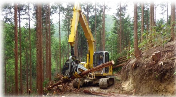
(森林作業道でのプロセッサによる造材作業)
