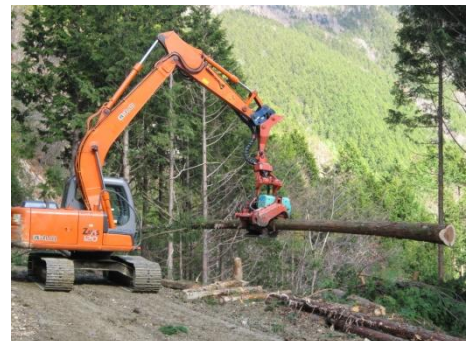
【高性能林業機械による間伐材の搬出】 (加子母裏木曾国有林)
