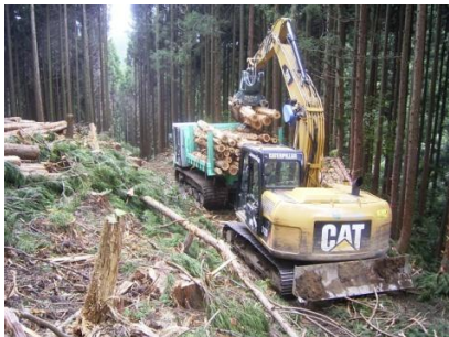
【高性能林業機械による間伐材の搬出】 (段戸国有林)
