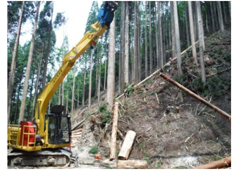
スイングヤーダーによる集材 (飛騨署)
