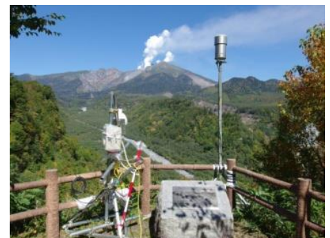
監視カメラと雨量計の設置
