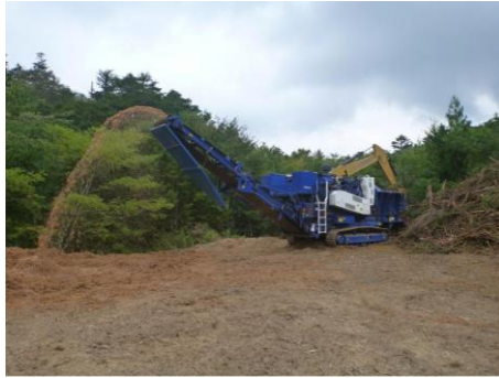
未利用材をチップヤードにて破碎（愛知所）
