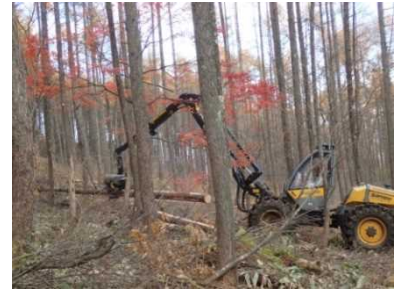
ハーベスタによる林内での伐倒、造材 (北信署)
