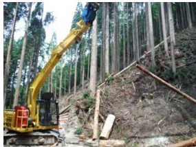
スイングヤードによる集材 (飛騨署)
