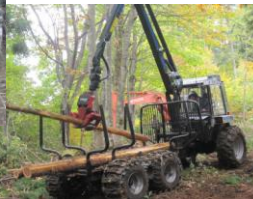
ハーベスタによる伐採 フォワーダによる積込（北信署）
