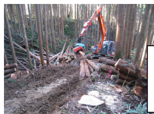
高性能林業機械による間伐材の伐採・搬出 (南木曽支署)
