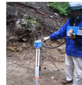
路盤支持力の測定 (森林技術センター)
