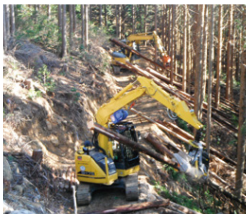
高性能林業機械(ハーベスター)での伐木造材
