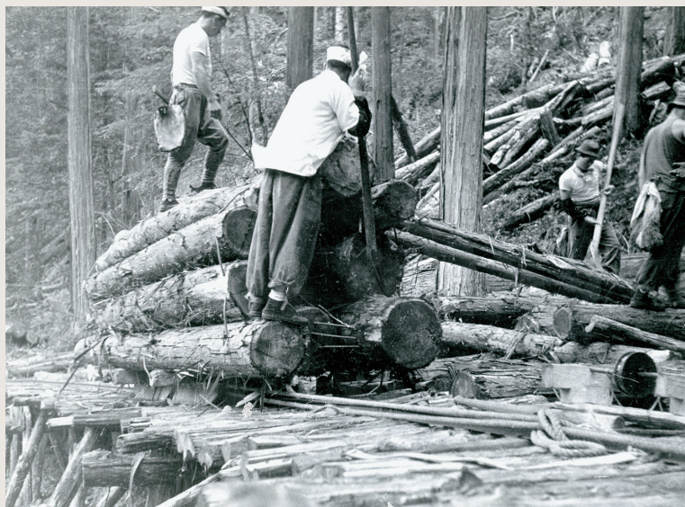
昭和30年頃の単軌木馬への積み込み (旧長野営林局管内)
