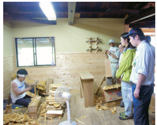
屋根葺き材のこけら製作
