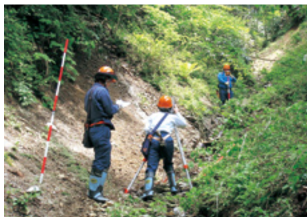
光波測距儀を使用している縦断測量
