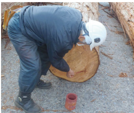
ベテランによる墨入れの様子
