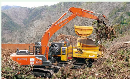
ヤマカ木材では、伐採後に発生する末木枝条等を集荷し、バイオマス燃料とするために現地でチップ化しています。これにより、この後の造林に向けた地拵えや植付けなどの仕事がしやすく、作業効率が上がります。
