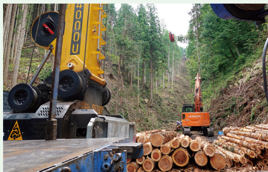
森林組合として全国で初導入したオーストリア製のタワーヤーダ(キャタピラ式)は、悪路や狭所の多い作業道をリモコン操作で自走でき、現場で活躍しています!
