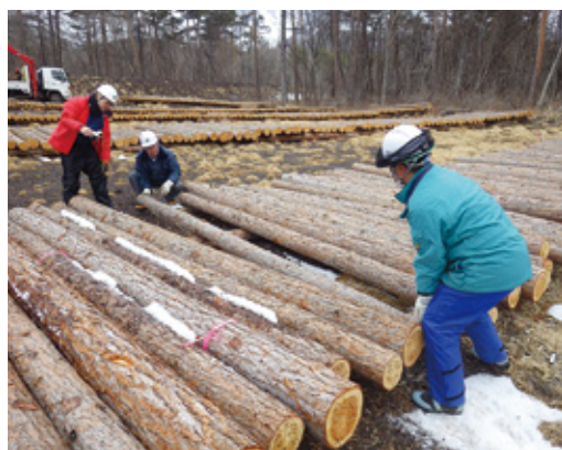
【写真左】曲がりや節の状況、皮むけや目まわり等の欠点を細かく確認
