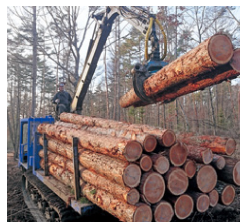
フォワーダに積込作業
