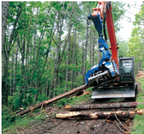
ハーベスタによる造材作業
