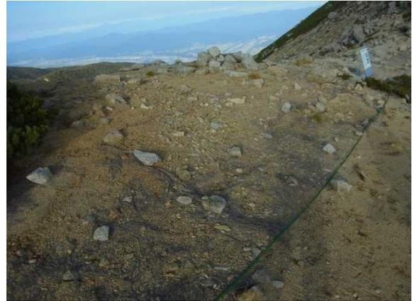
3 年を経過したヤシマット。風衝地では劣化、損傷が顕著である。
