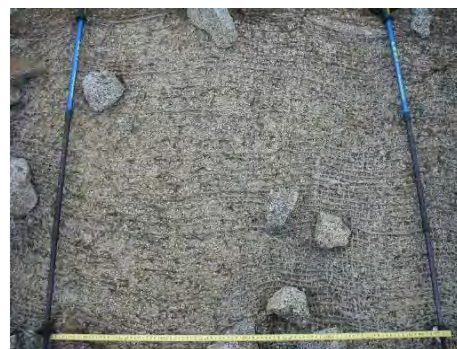
プロット No. 九-1 マットがほぐれ、表土の一部が流失している
