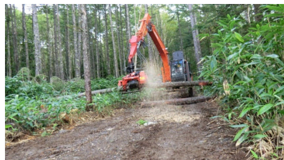
（プロセッサによる造材作業）
