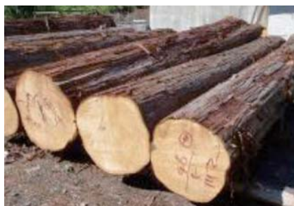
善光寺三門修復工事の資材となった天然サワラ
