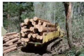
フォワーダによる運材作業
