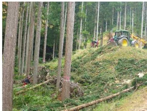
写真-3. 4 間伐実施林分でのウインチ集材作業
