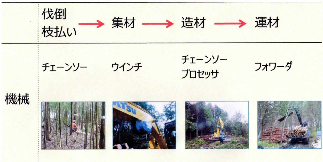
図-6 作業システム
