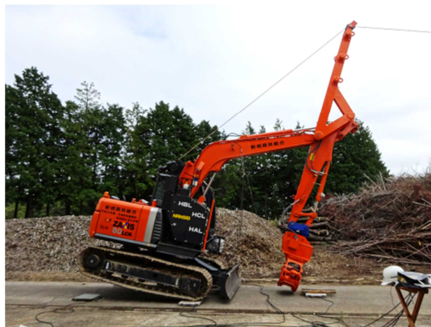
写真-2 アーム未接地において車体が傾いた様子
