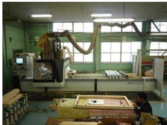
写真4.(2).ア 木製サッシ加工専用の完全制御5軸加工機
