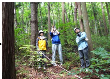
写真 27 ブルーメライスを使い、20m離れた位置で、樹高を測定しました。
