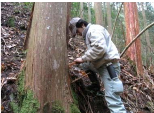
写真3 へらで立木の形成層と樹皮の間に差し込み、樹皮をはぎ取る
