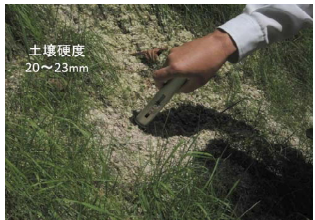
写真-17 土壌硬度の調査状況
