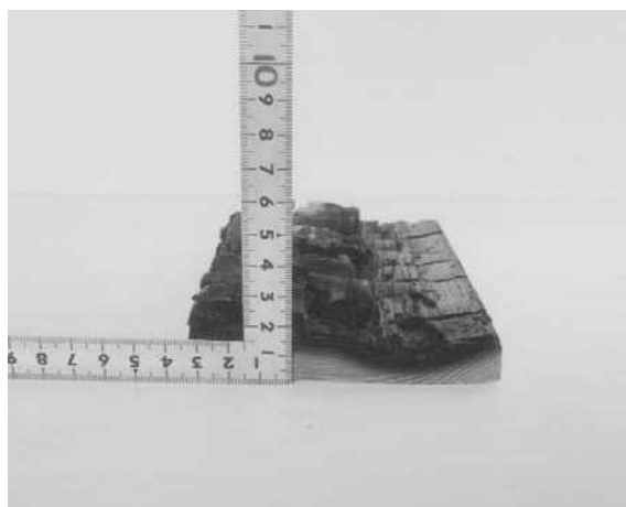
試験後の信州カラマツチャンネルサイディング
