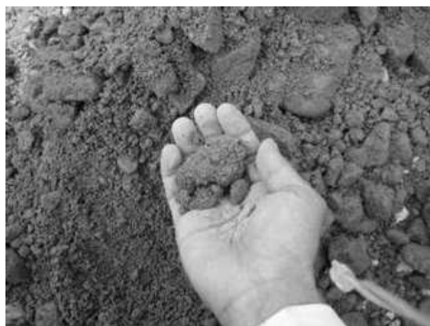
写真-6 製造直後のソイルセメント
