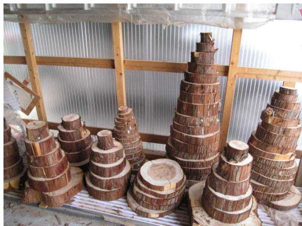
各国有林より採取した2m刻みの年輪板
