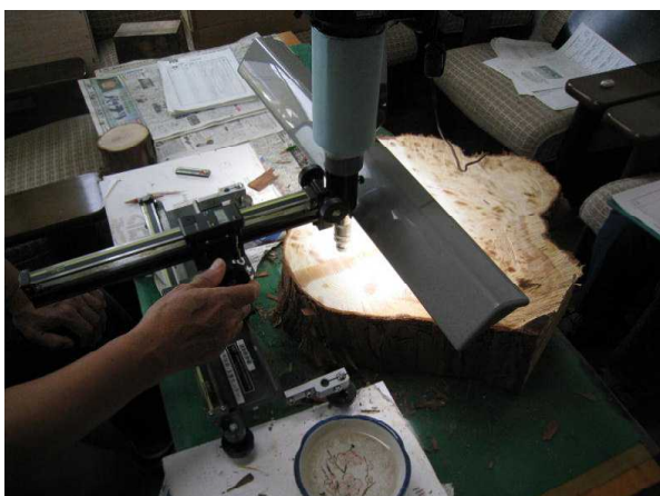
読み取り顕微鏡による読み取り
