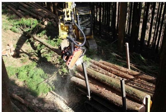
プロセッサにより直接フォワーダへ積み込みと造材
