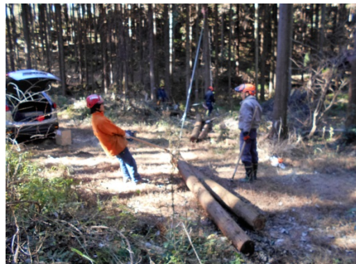
▲ポータブルウィンチで間伐材を搬出
